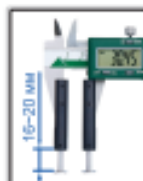
измерение диаметра внутреннего паза (h ≤ 3.5 мм)
