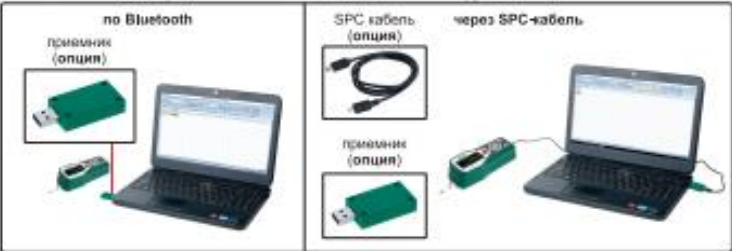
данные можно отправлять в Excel, подключившись к компьютеру по Bluetooth или SPC-кабелю
